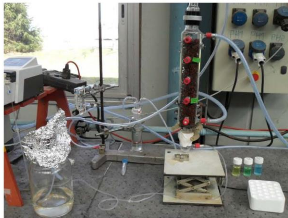
Illustration 2: Essai de biodégradation des thiocyanates en colonne de 100 mL.
