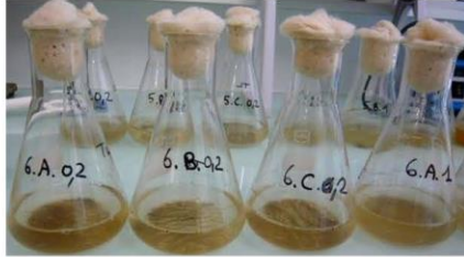
Illustration 1 : Essais en batch : Erlenmeyers cotonnés, traitement par ajout de Fe II ou Fe III avec, agitation à 25°C.
